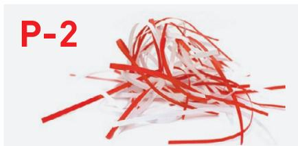
Empfohlen z.B. für Datenträger mit internen Daten, die unlesbar gemacht werden sollen (z.B. Streifenschnitt 6 mm).
