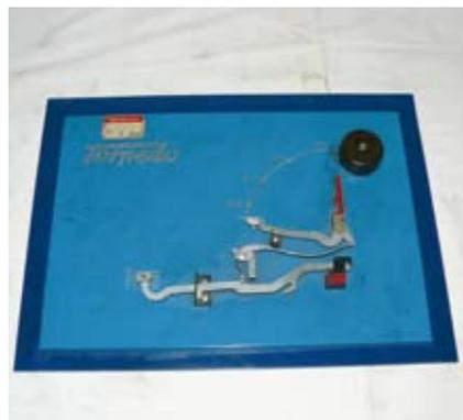
Typenhebelübersetzung von Torpedo;
