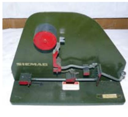
Typenhebelübersetzung von Siemag;
